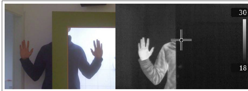
Abbildung 3.4: Abschirmung durch eine Türe mit Fensterglas (©REICHARD 2013)
