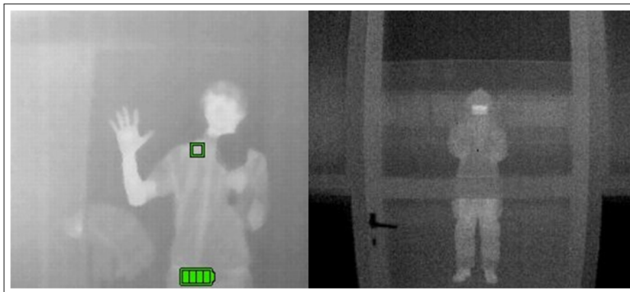
Abbildung 3.3: Spiegelung in einer Metalltür eines Schaltschranks (links) und in einer Glastür (rechts) (©REICHARD 2013)
